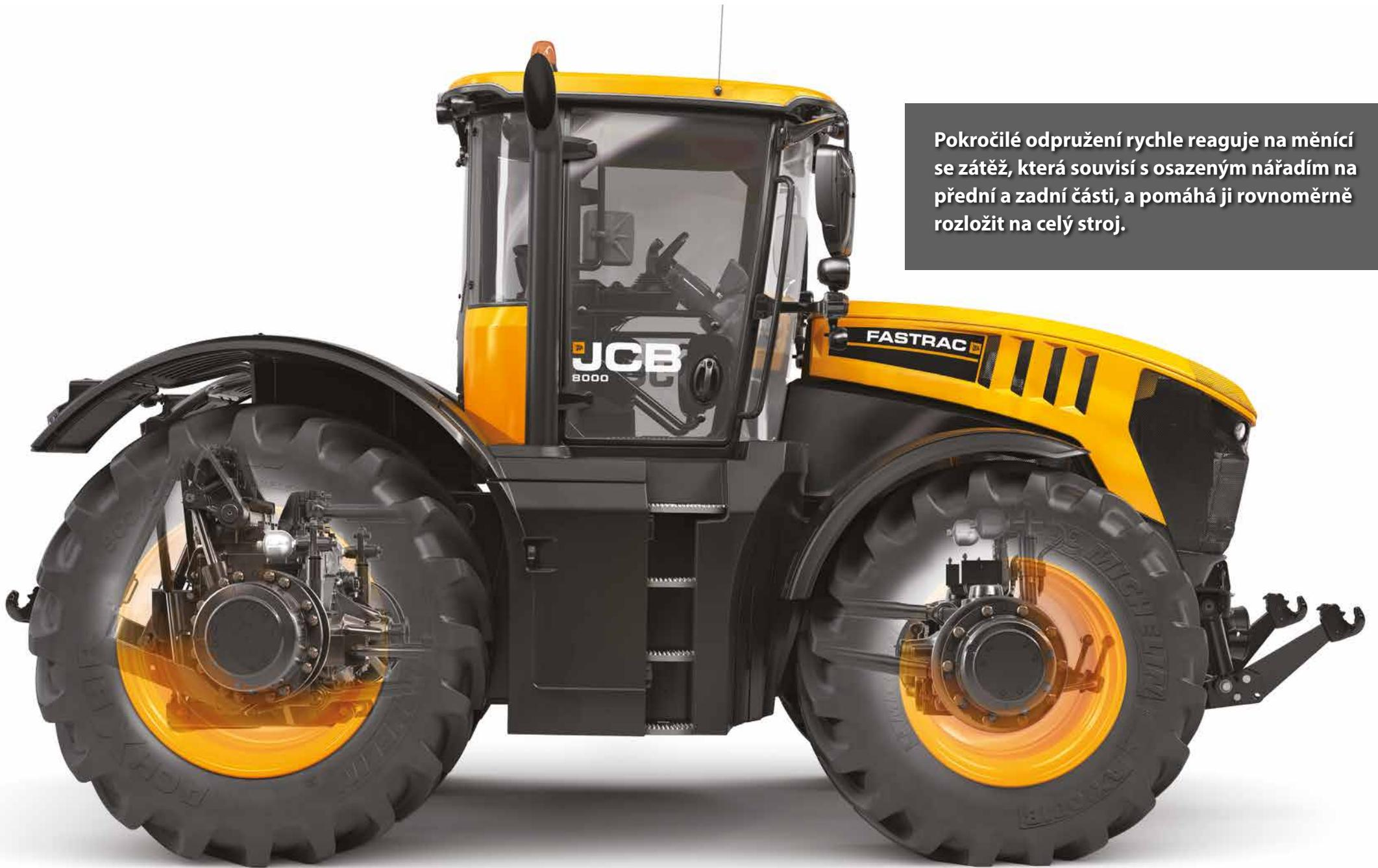
Pokročilé odpružení rychle reaguje na měnící se zátěž, která souvisí s osazeným nářadím na přední a zadní části, a pomáhá ji rovnoměrně rozložit na celý stroj.
