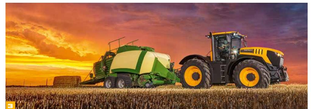
**Výkonná hydraulika si hravě poradí díky 6 dvojčinným elektronickým proporcionálním ventilům a snímání zátěže za připojením. 140 l/min na ventil odděluje dodávku oleje, která je zvlášť mimo převodovku, aby se zabránilo znečištění.**
