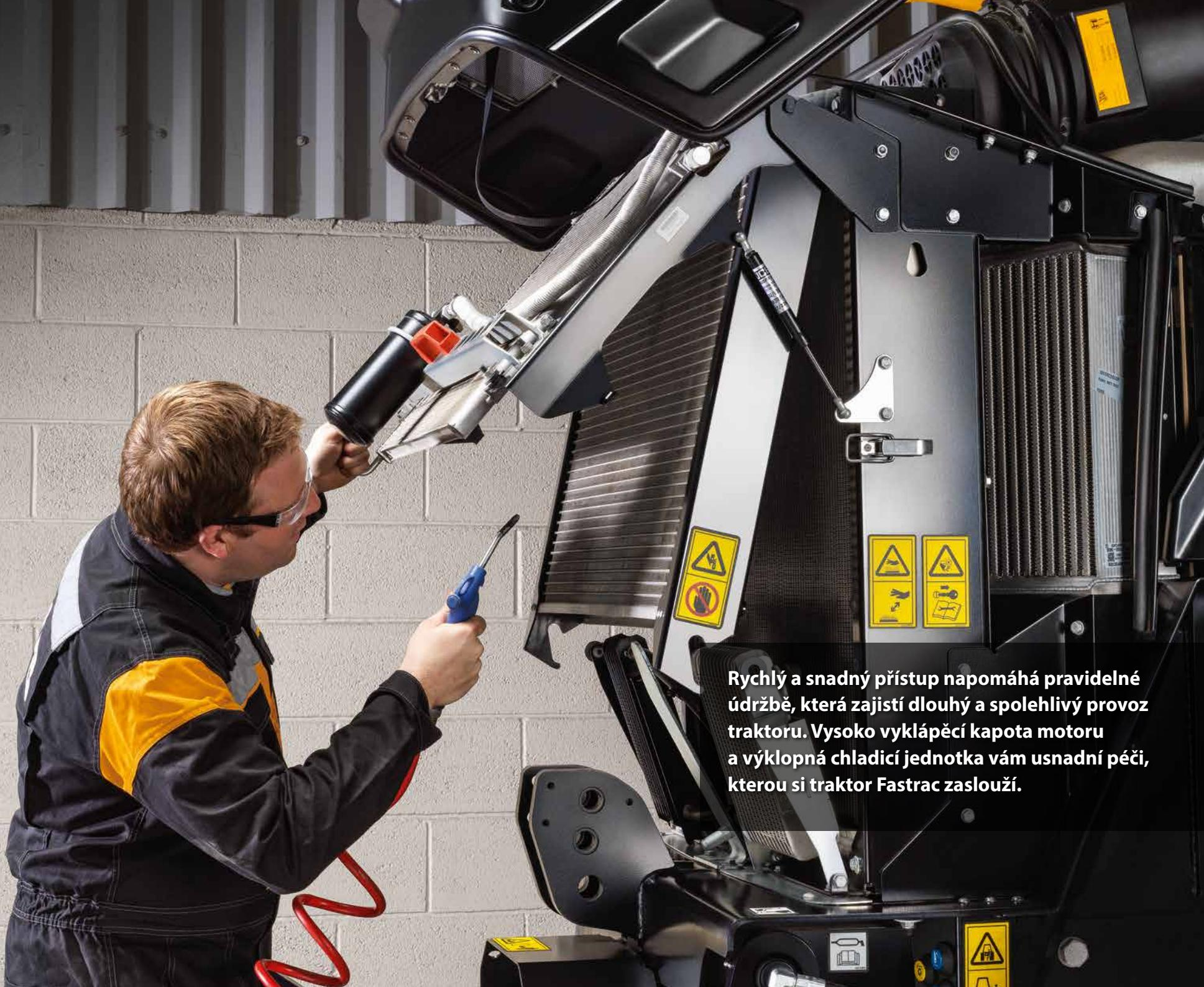
Rychlý a snadný přístup napomáhá pravidelné údržbě, která zajistí dlouhý a spolehlivý provoz traktoru. Vysoko vyklápěcí kapota motoru a výklopná chladicí jednotka vám usnadní péči, kterou si traktor Fastrac zaslouží.
